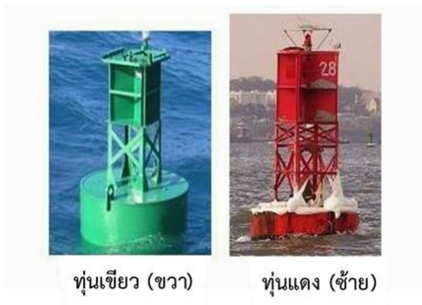
รูปที่ 14 ตัวอย่างทุ่นไฟในระบบแบบ A สีแดงเป็นด้านซ้าย (Star Broad) และด้านฝั่งท่าเรือ (Port Side) สีเขียวเป็นด้านขวา
